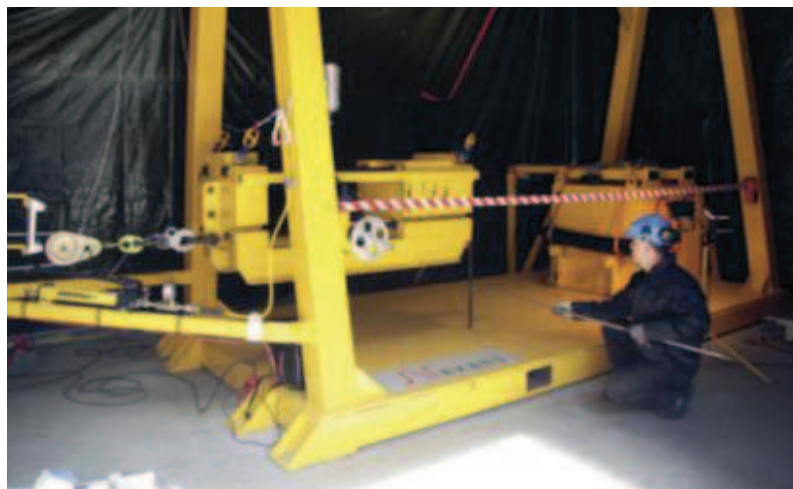
SLAGSKADER: Impact-riggen (Horisontal pendelrigg), benyttes til å kartlegge skadeområdet på kabel ved slag fra f.eks en trålelem fra fiskefartøy. Riggen er utstyrt med bl.a. høyhastighetslasers og akselerometer for å kunne beskrive bevegelsen til hammeren idet den treffer testobjektet.
