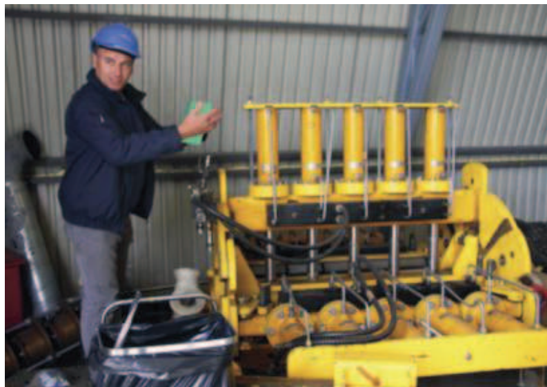
VISER FRAM: Avdelingsleder Lars Jordal ved Mekanisk Test Senter ved Lateral Load Rig. Testriggen benyttes til å få verifisert hvor mye klemkrefter man kan tilføre en kabel/umbilical under installasjon offshore.
